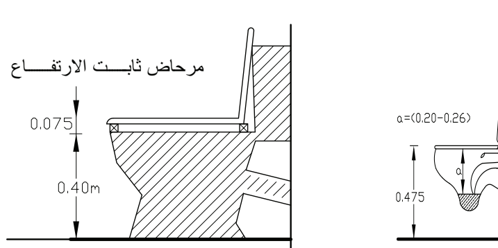
الشكل (6-25) الارتفاعات المناسبة لمراحيض الافرنجية .
