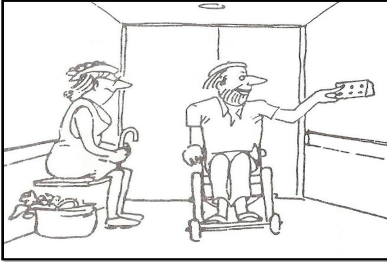
الشكل (18-2): مقعد قابل للطي داخل عربة المصعد.
